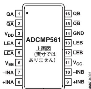
図4. ADCMP561、16ピンQSOPのピン配置
